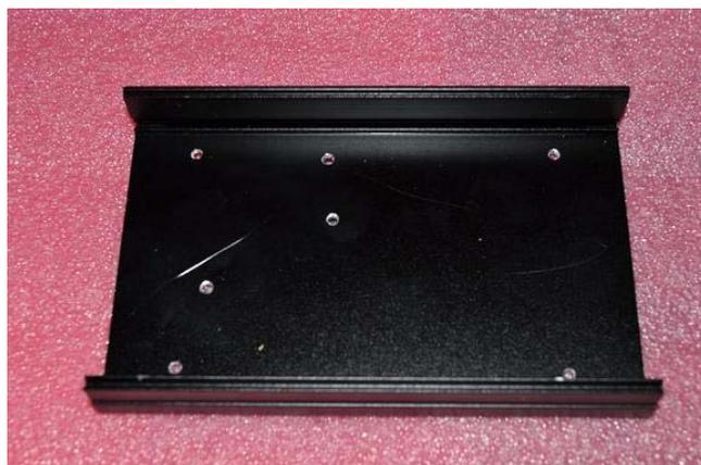
[ ] 7 個の M3 用取付穴を開けます。4ヶ所のケース足用穴の位置は多少ずれても大丈夫です。3ヶ所の半導体取付穴に関しては慎重に位置を確認してから加工して下さい。ドリルの穴あけ位置は十分に注意して下さい。穴開け後はバリを取り除いて下さい。
