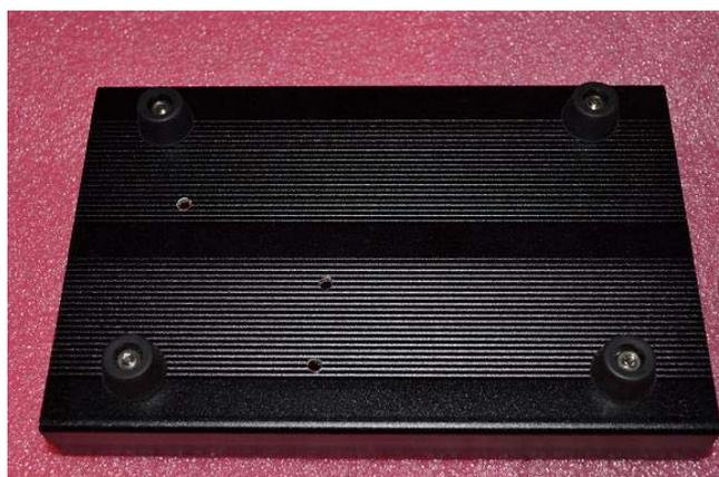
[ ] 基板を溝に差し込んで滑らせ基板の角穴とネジ穴が一致することを確認して下さい。また基板の底を覗いてケースとの間でショートや、引っかかっているようなものが無いかを確認して下さい。
