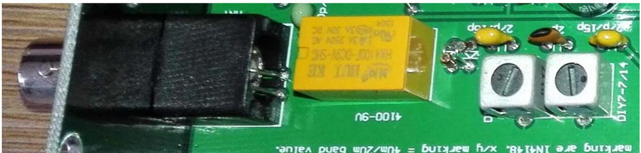
[ ] ここで調整をしながら実際のバンドを受信して楽しみましょう。11-13.8 V の安定化電源、スピーカを接続します。ANT 端子にアンテナ線を接触させるとスピーカから大きなバンドノイズが受信できます。TUNE ダイアルをゆっくり回して QSO が聞こえるかどうか試してみてください。バンドのノイズか QSO 信号を聞きながら、最大になるよう 2 つの IFT コアを回して受信 BPF を調整して下さい。TUNE ツマミをゆっくりと回すと、100Hz ステップの微調整ができます。オーディオのスペクトルが正常でないか、フガフガとした音声しか聞こえない場合は、BFO 周波数を少しずつ調整し、スピーカから大きく明瞭な声が聞こえるようにします。もし正常でない場合には、ハンダ付けを再度チェックして下さい。OK なら、DC 電源、スピーカを外して次のステップに進みます。
