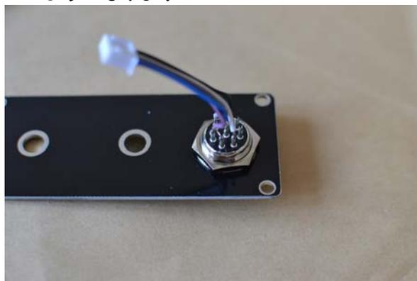
[ ] 最初に 2 個のノブにナットがあるか確認します。マイクケーブルを SIP5 ソケットで基板に接続し、2 個の黒いケース用ネジでフロントパネルを固定します。フロントパネルの穴から LED と 2 個のノブが飛び出しており、ワッシャと残りのナットを締めた上で、最後に 2 個のノブを取り付けて
