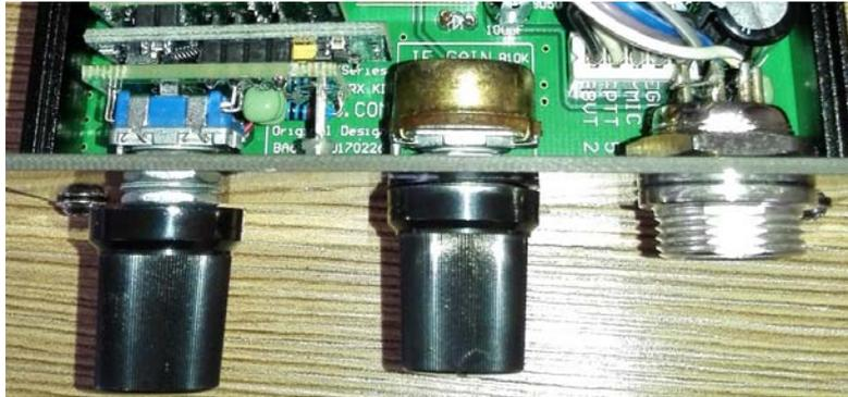
[ ] IF GAIN を中間程度にセットして調整を開始します。調整が完了したらケースの上蓋を閉じ4つの黒いケース用ネジで固定するのを忘れないようにして下さい。
